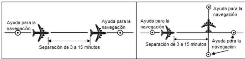
Figura 2. Separación mínima entre aeronaves que siguen la misma derrota y aeronaves con derrotas cruzadas.
