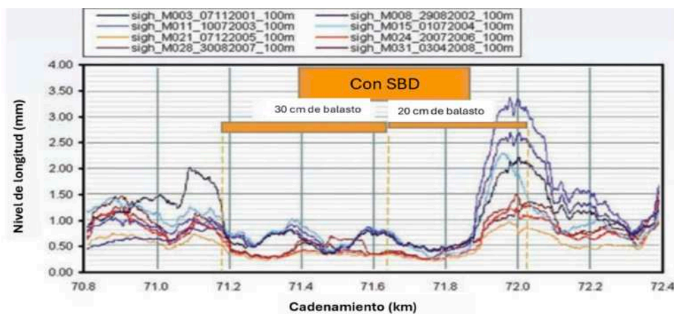
Figura 7. Desviación estándar de nivel longitudinal del riel como una medición de la calidad de la geometría de la vía.
