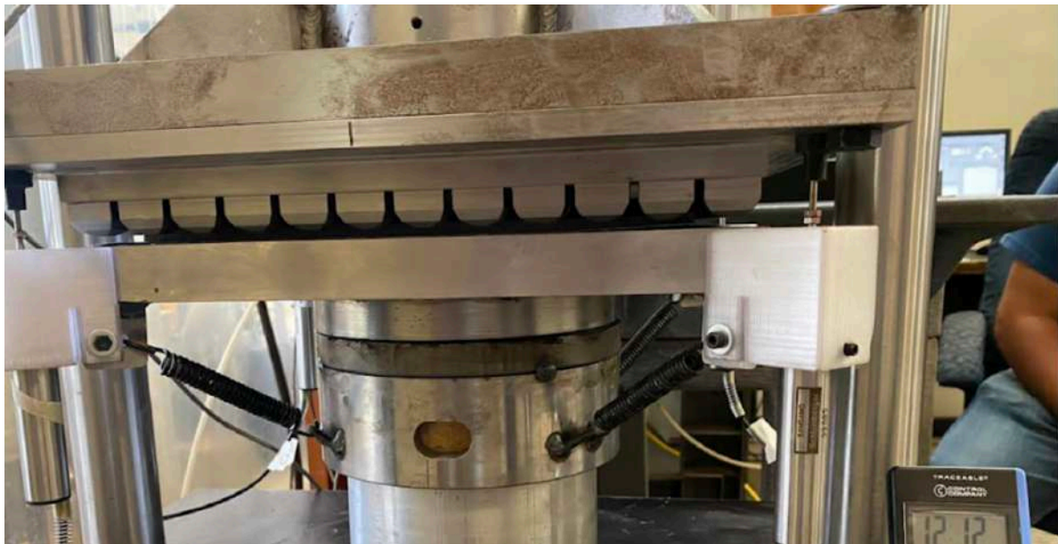
Figura 10. Ensayo de módulo de rigidez sobre Suela bajo durmiente en el IMT con placa geométrica de balasto.
