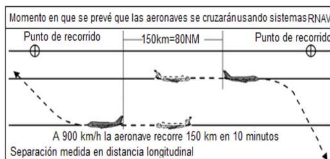
Figura 1. Separación mínima entre aeronaves que siguen derrotas opuestas utilizando sistemas RNAV.
