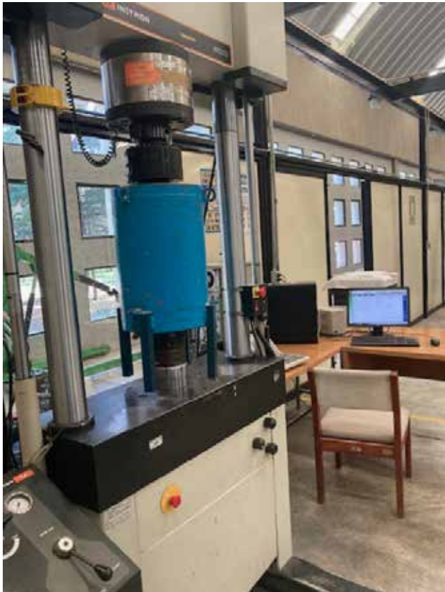
Figura 3: Arreglo de prueba de ruptura de partícula, aplicación de carga cíclica en ensayo de ruptura de partículas
